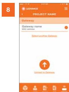
Sube la preconfiguración al controlador VIVARES
